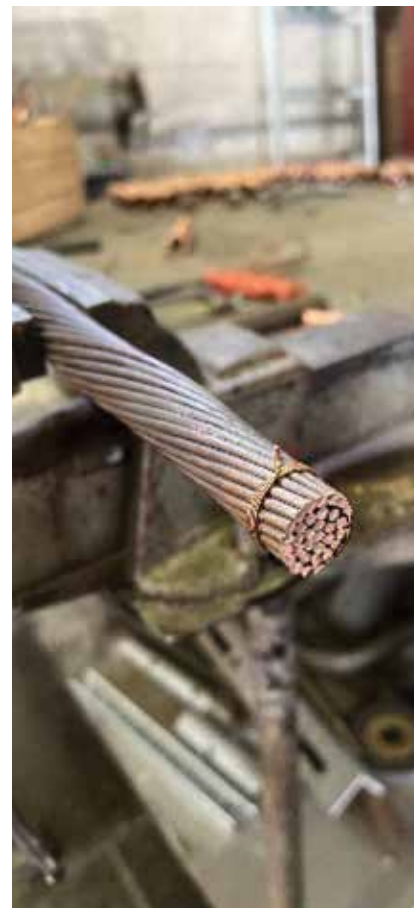
Figura 3: Resultado do corte utilizando o Cortador movido a Bateria Fonte: Acervo CPTM
